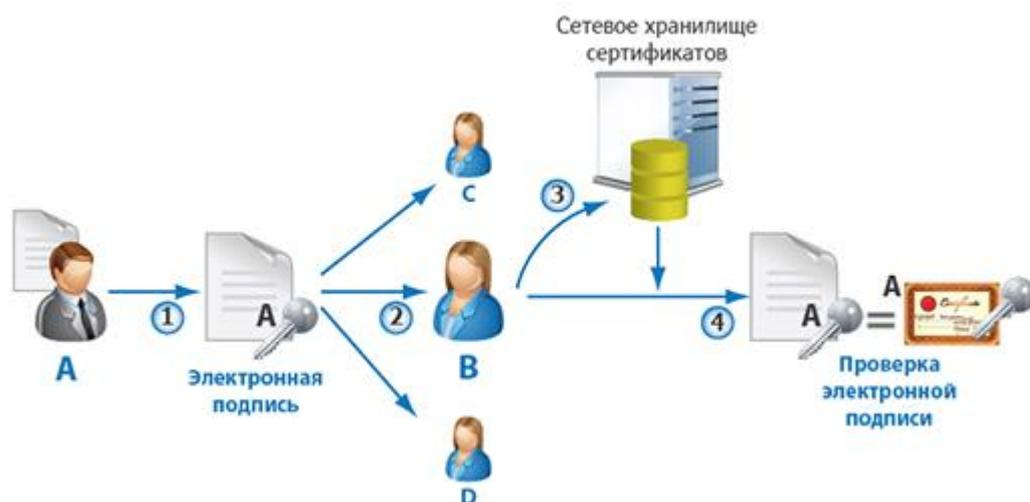
Рисунок 3. Процесс формирования и проверки электронной подписи документа
