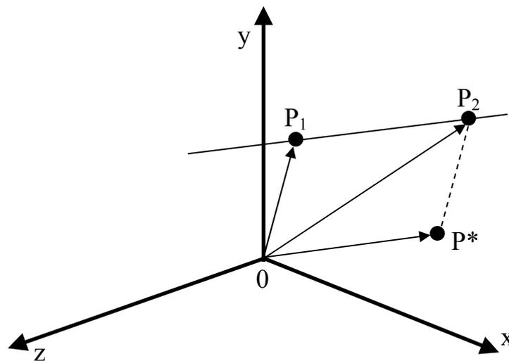
Рис. 5.3. Вывод уравнения прямой в трехмерном пространстве
