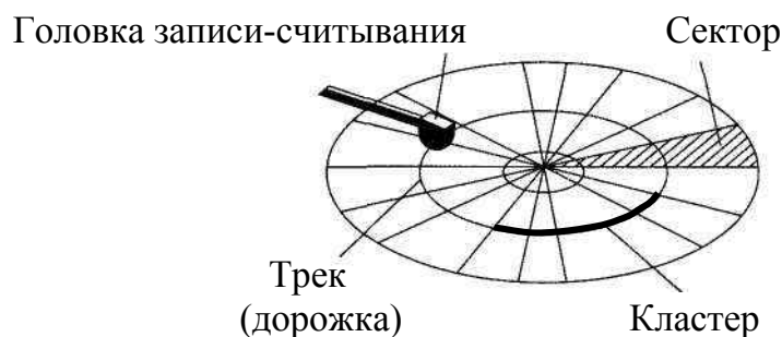
Рис. 9.2. Магнитная запись цифровой информации
