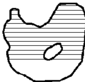
Рис. 2.15. Работа модифицированного рекурсивного алгоритма с «затравкой»
